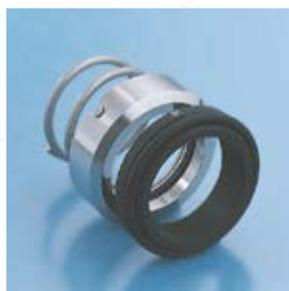
Epurée à l'extrême, **LATTY®seal U 1000** est la garniture mécanique de référence pour une large variété d'équipements à la norme NF EN 12756. Endurance et simplicité sont tous deux facteurs de longévité et de facilité d'installation. Son concept à ressort conique la rend dépendante du sens de rotation.
