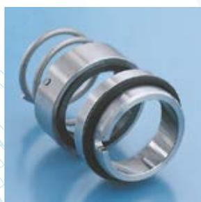
D'un concept similaire à **LATTY®seal U 1000** mais dotée d'une face en carbone, **LATTY®seal U 1112 R** remplit un large spectre d'applications dans les nombreux équipements à la norme NF EN 12756. Son concept à ressort conique la rend dépendante du sens de rotation.
